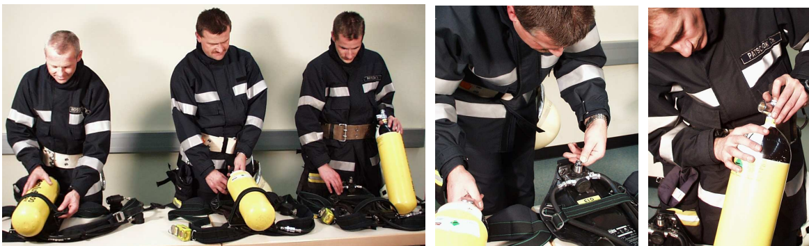
Abbildung 31: Flaschenwechsel, Kontrolle der O-Ringe und Ventile
